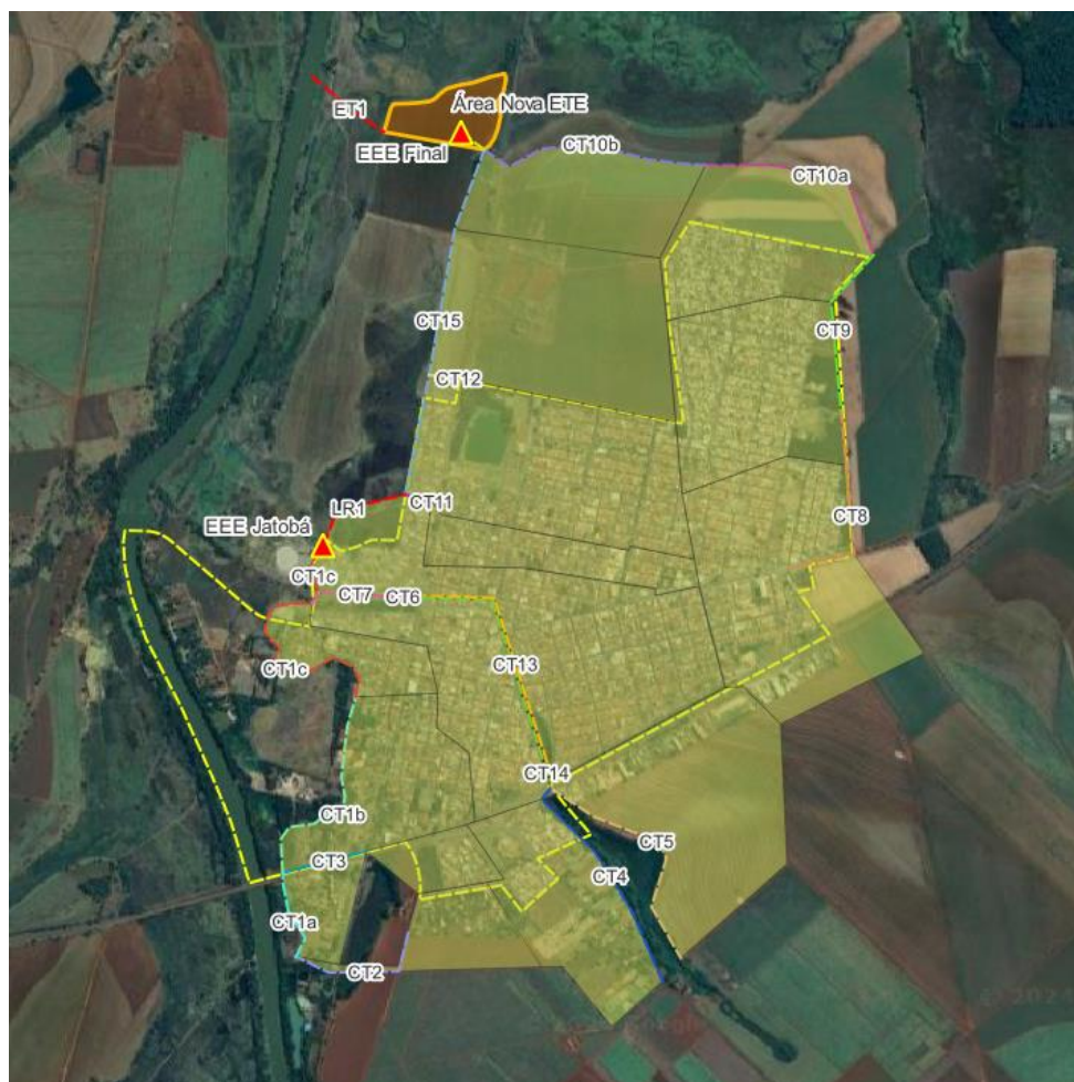
Figura 28 - Concepção do sistema de esgotamento Sanitário.
